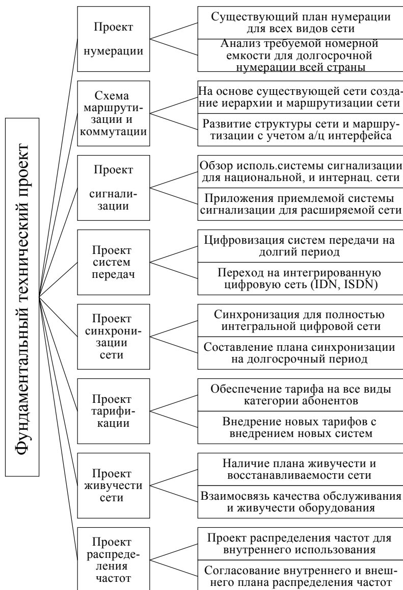
Рис. 1.6. Фундаментальный технический проект
