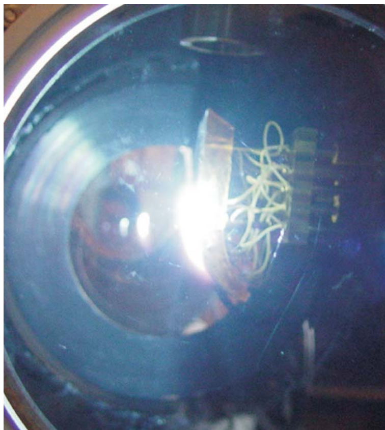
Рис. 22: Фотография разряда сбоку. Частота генератора 13.56 МГц, p = 70 Торр, T = 170 К, воздух, M = 2
