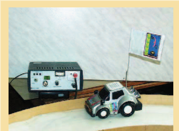
Рис. 12. Макетный образец электромобиля с электро-снабжением от однопроводниковой кабельной линии, проложенной в дорожном покрытии
