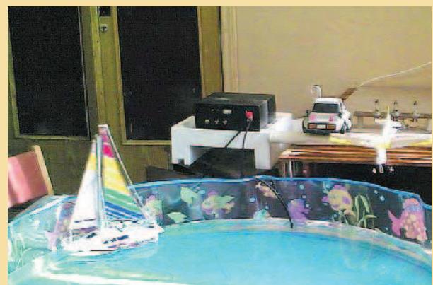
Рис. 11. Испытания макета электрического речного судна в лаборатории ВИЭСХ с использованием водопроводной воды в качестве проводящей среды
