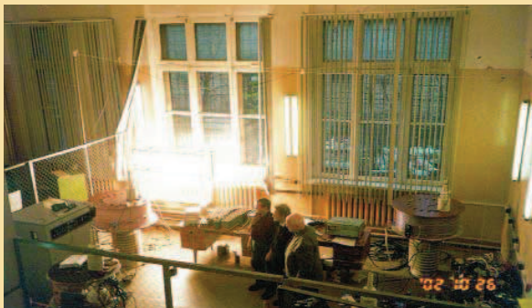
Рис. 9. Испытания резонансной энергетической системы 20 кВт с однопроводниковой кабельной линией 1,2 км в лаборатории ВИЭСХ
