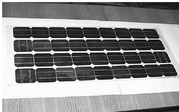
Рис. 3. Солнечный фотоэлектрический модуль Размеры 450 × 970 мм. Электрическая мощность 40 Вт. Напряжение 12 В.
