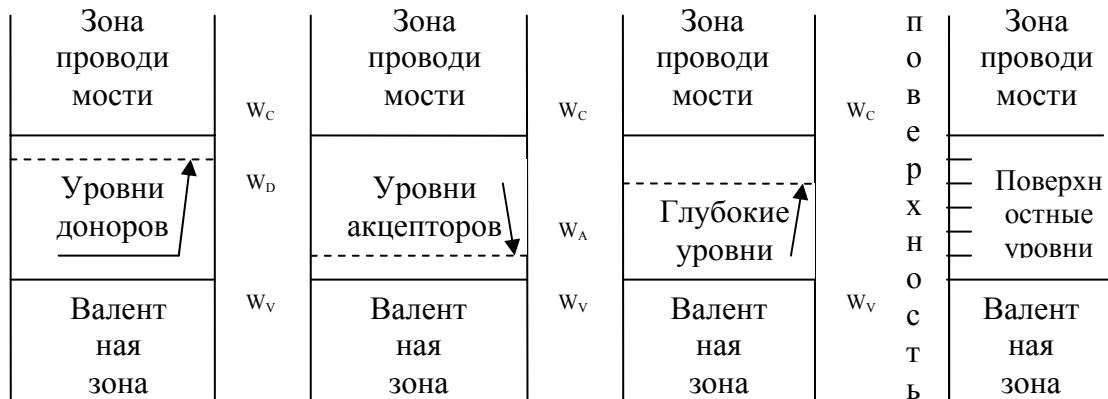
Рис.1.8 Зонные диаграммы примесных полупроводников
