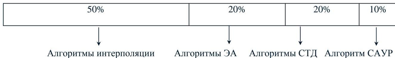
Рис.3.4.20. Распределение времени таймерного интервала на решение задач ЧПУ
