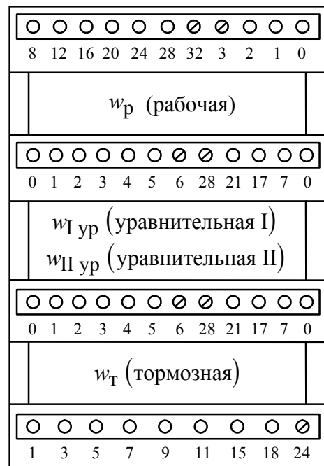
Рис. 16. Клеммные панели реле ДЗТ-11
