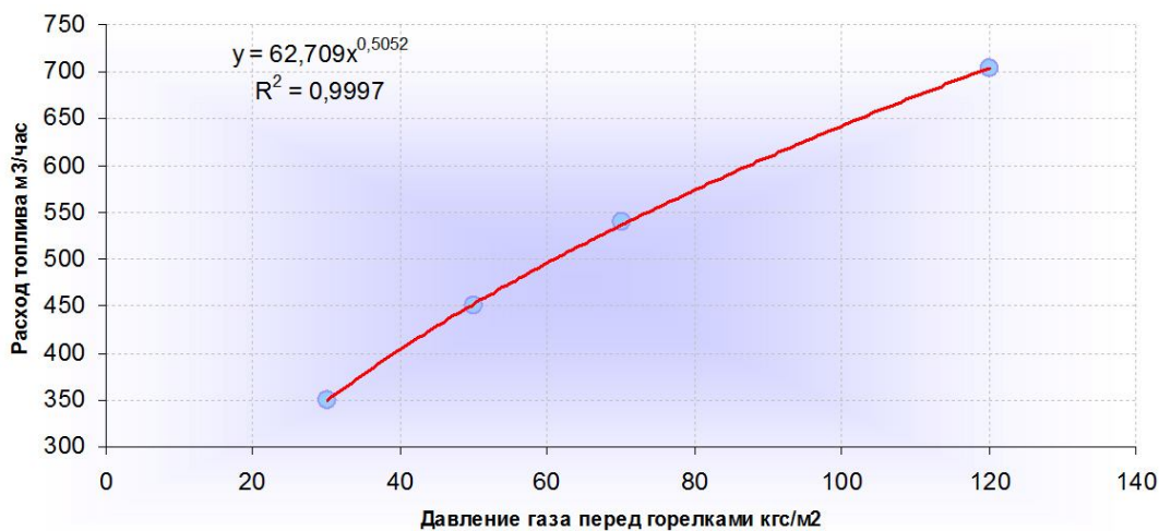
Рис. 2. Зависимость расхода природного газа от давления газа перед горелками согласно данным режимной карты котлоагрегата ( y = 62,709x^{0,5052} ).
