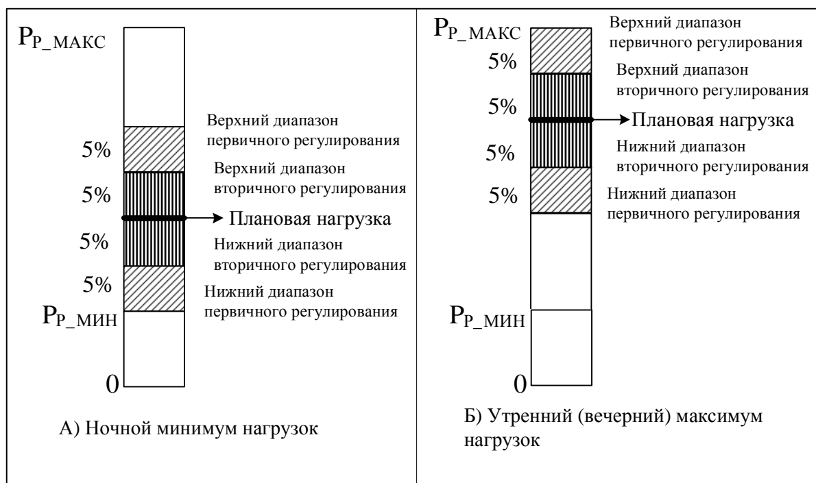
Рис. 4.7. Размещение плановой нагрузки и диапазонов регулирования при отсутствии диапазона третичного регулирования
