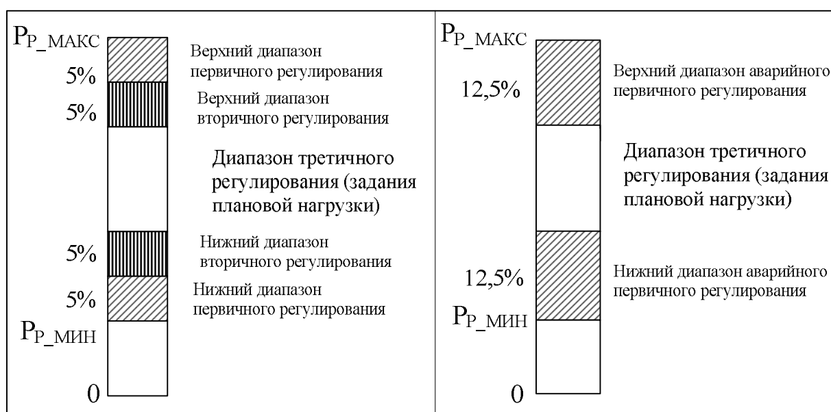
Рис. 4.6. Размещение диапазонов регулирования
